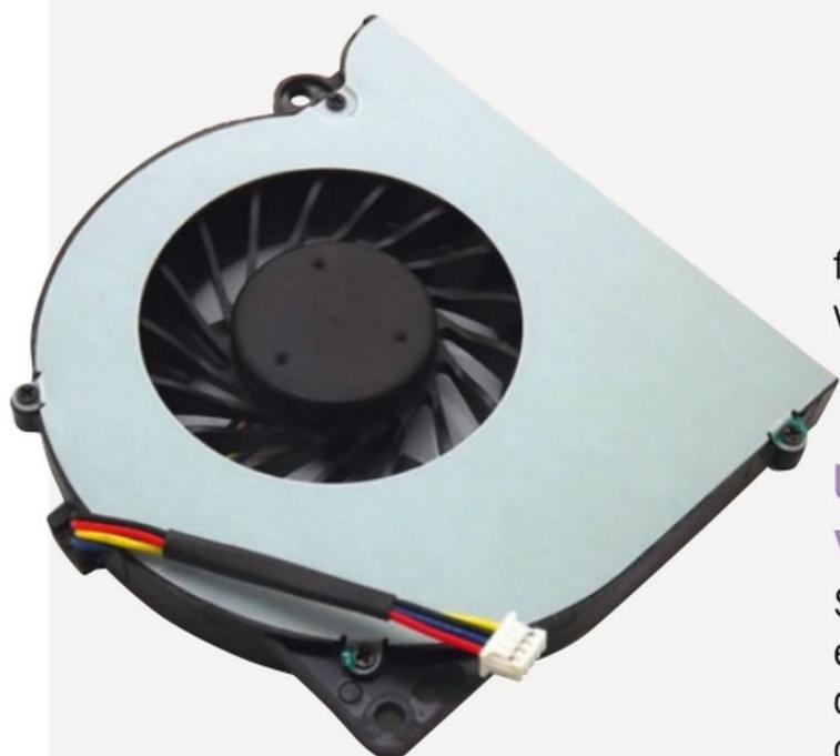
▲ Les ventilateurs d'un ordinateur portable s'encrassent vite et nuisent au bon refroidissement des composants comme le processeur ou la puce vidéo.
