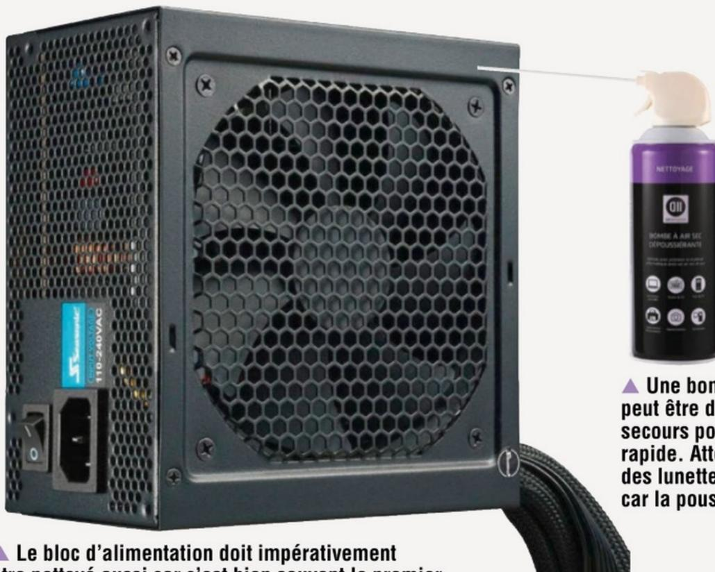
▲ Une bombe d'air sec peut être d'un grand secours pour un nettoyage rapide. Attention à mettre des lunettes de protection, car la poussière va voler.
