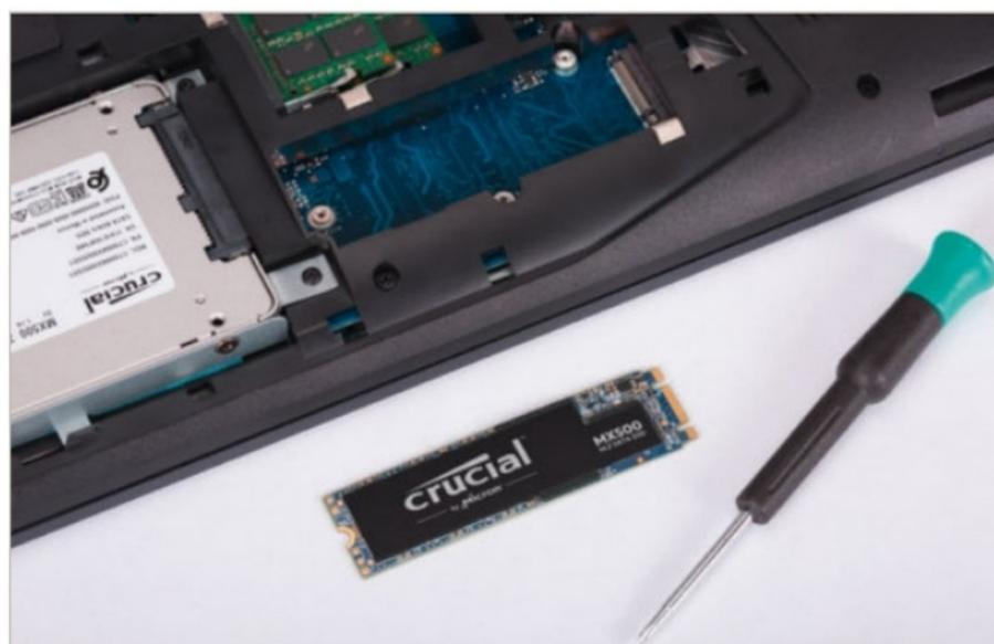
▲ Une seule vis tient un SSD M.2 en place à l'intérieur.
